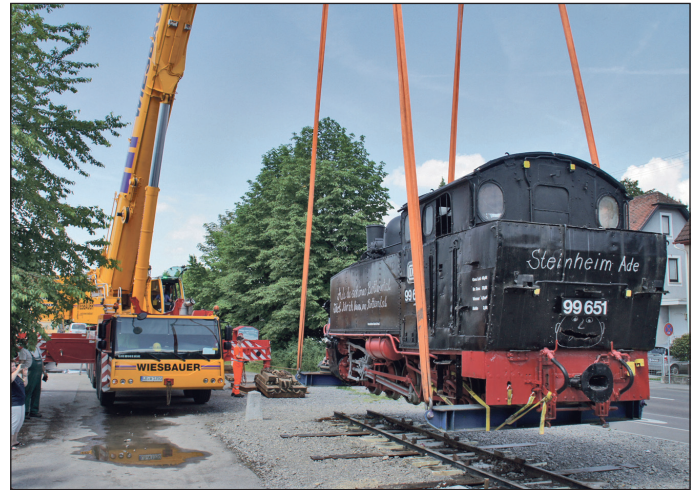
10. Juni 2016: Die Lok wird mit einem Autokran auf einen Tieflader gesetzt und nach Ochsenhausen transportiert. (Foto: Wolfram Berner)
